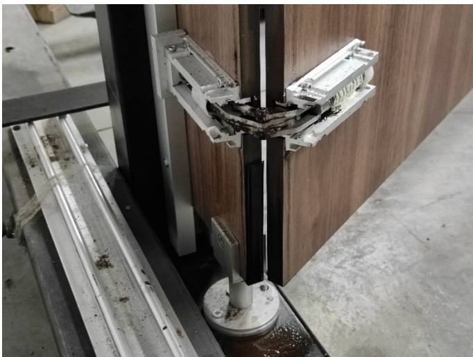
Fotografie della cerniera inferiore al termine della prova in posizione di apertura e di chiusura
