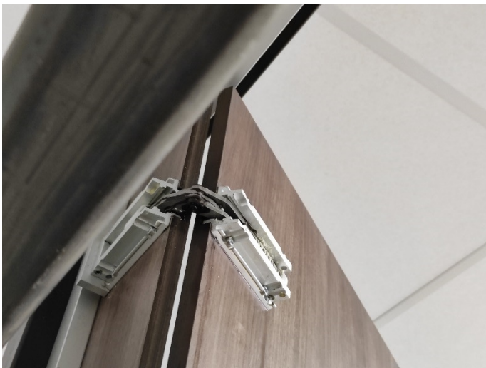
Fotografie della cerniera superiore al termine della prova in posizione di apertura e di chiusura
