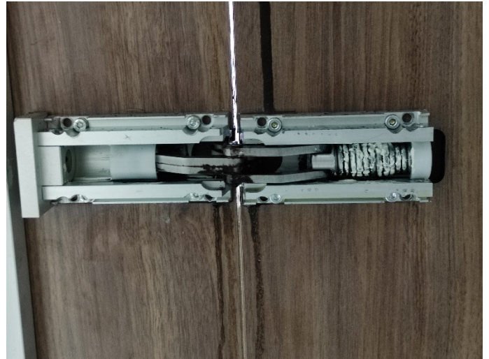
Fotografie della cerniera centrale al termine della prova in posizione di apertura e di chiusura
